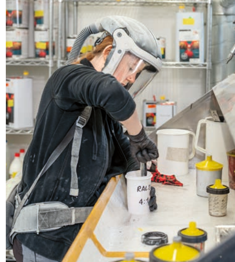
▲ Die Industrielackiererin mischt den Farbton genau nach Rezept.
