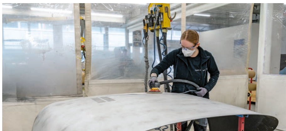
▲ Im «Spot Repair» entfernt eine Absauganlage den Schleifstaub aus der Luft.
